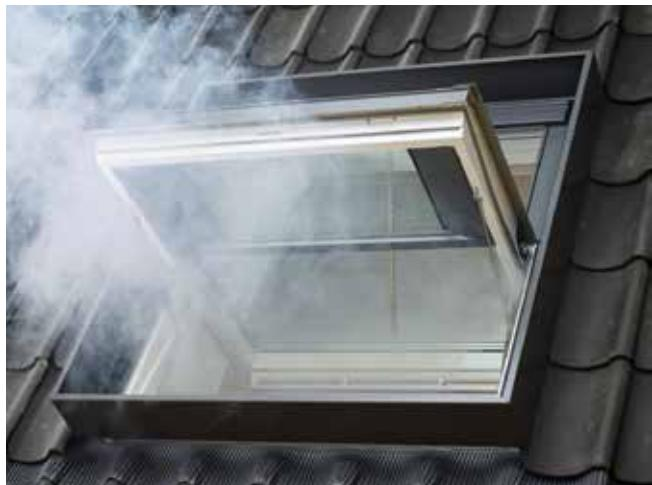
Системот за вентилација на чад во случај на пожар автоматски го отвора прозорецот и дозволува излез на чадот. Освен тоа, прозорецот овозможува се што и редовните функции на прозорци - дневна светлина и вентилација. Системот може да се поврзе со противпожарни системи на други производители и е тестиран во согласност со европскиот стандард EN 12101-2. Се состои од кровен прозорец и систем за контрола на чад (KFX 210).
